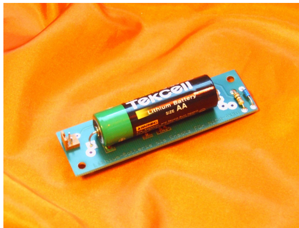
Spezial-Lithiumzelle mit zusätzlicher Schutzbeschaltung (Anschlussleitung mit Stecker nicht abgebildet)
